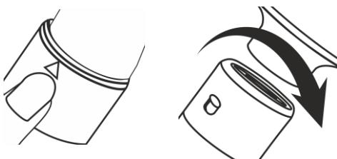
Для замены или снятия насадки после окончания работы нажмите и удерживайте кнопку-фиксатор насадок и повернув насадку вправо снимите ее с фена.
