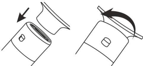
Для установки насадки наденьте ее на корпус прибора и зафиксируйте, повернув с небольшим усилием влево до щелчка.
